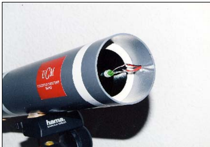
FOTO 5, Detalle del frontal de MeCO. Obsérvese la complicada posición del LED verde
