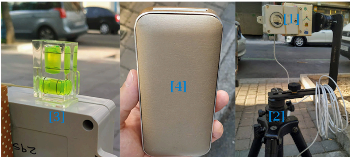
Fig. 2. Fotómetro TESS-W [1]. Trípode con cabeza panorámica [2]. Nivel de Burbuja [3]. Batería portátil [4].
