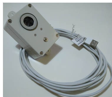
Figura 2.3: Fotómetro TESS usado en este trabajo.
