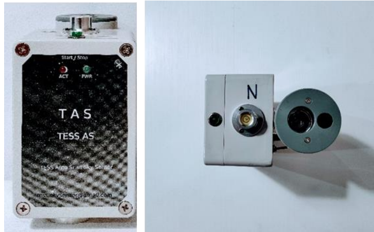
Figura 1: Vistas del Fotómetro TASS empleado en este trabajo. Imagen frontal (izquierda) y cenital (dcha.). En esta última se aprecian la ventana del fotómetro y el sensor IR con un tamaño de 10 cm. de alto, 7 cm. de ancho y 5 cm. de grosor.
