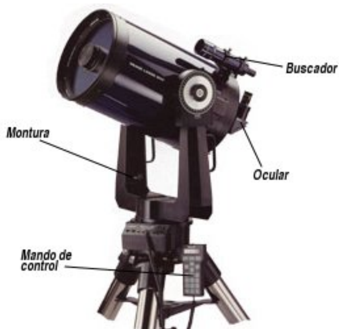
Figura 2.1: Telescopio utilizado: Meade LX200.
